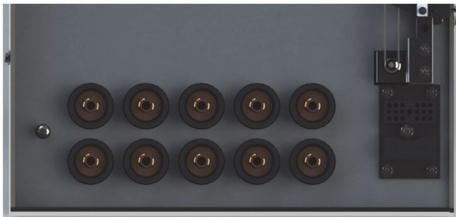
Slika 9. Prikaz konstruiranog sustava-fokus na raspored kućišta mlaznica
