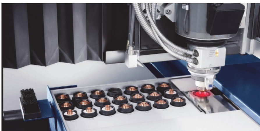
Slika 5. Primjer automatske izmjene mlaznica na laserskom stroju – TRUMPF
