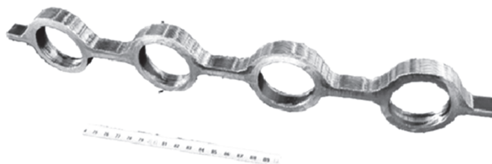
Slika 4. Ispitni uzorak za mjerenje tvrdoće
