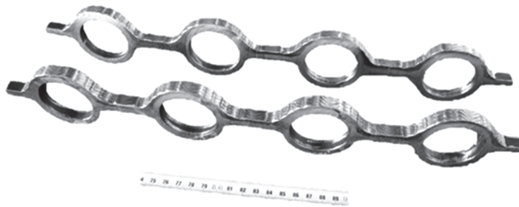
Slika 5. Ispitni uzorci za ispitivanje savijanjem
