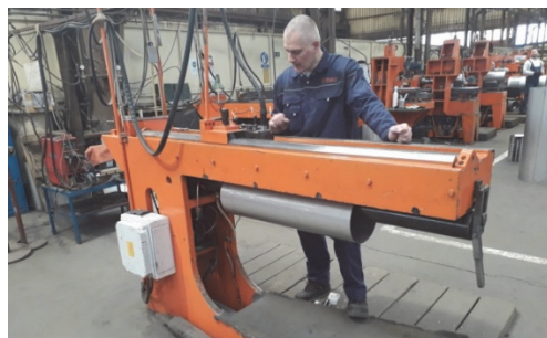
Slika 4. Stroj za uzdužno zavarivanje cijevi
