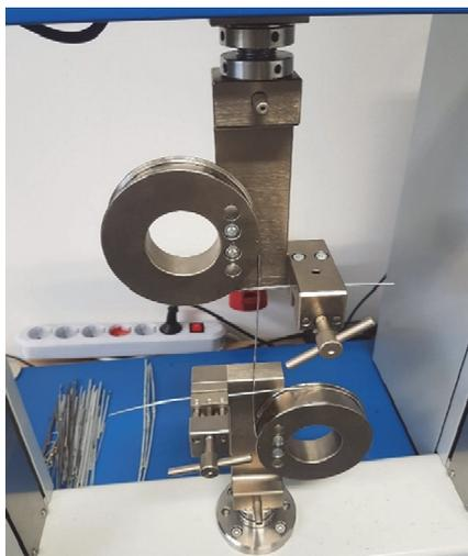
Slika 2. Kontrola vlačne čvrstoće na kidalici [2]
