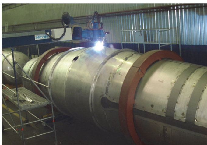
Slika 12. Zavarivanje dvaju polovica spremnika u napravi
