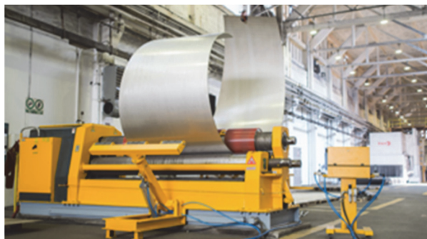
Slika 8. Savijanje plašta cisterne
