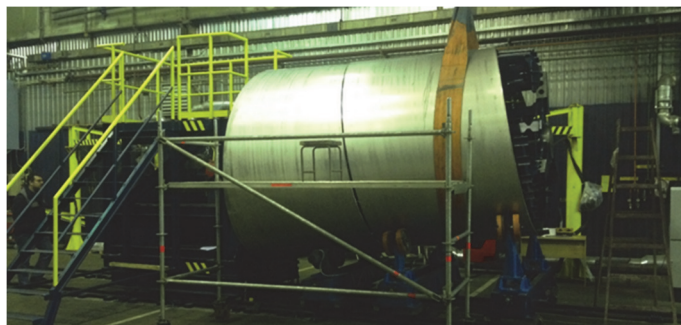
Slika 10. Naprava za zavarivanje segmenata plašta cisterne
