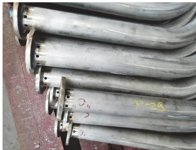
Slika 8. Savijeni priključci zraka sa zavarenim poklopcem
