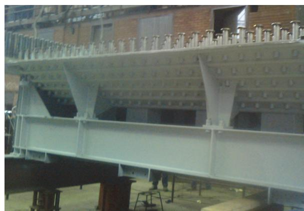
Slika 18. Priprema za provođenje antikorozivne zaštite rešetke
