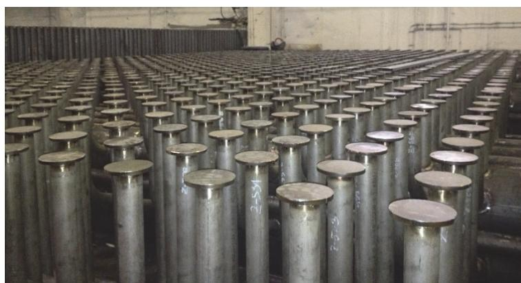
Slika 2. Priključci za dovod zagrijanog zraka
