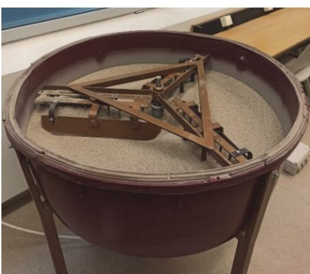
*Slika 3. Izgled uređaja za trošenje u masi abraziva*
