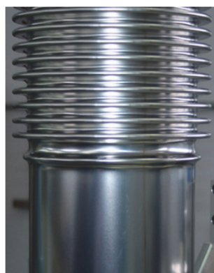
Slika 15. Oblikovanje mijeha ekspandiranjem [1]
