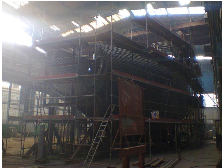
Slika 10. Spoj konusa i cilindričnog membranskog zida
