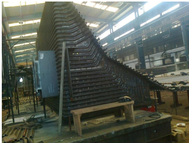
Slika 7. Ugradnja membranskih otvora
