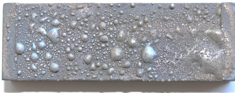
Slika 1 Fotografija loše naštrcanog uzorka, NiCrBSi prevlaka
