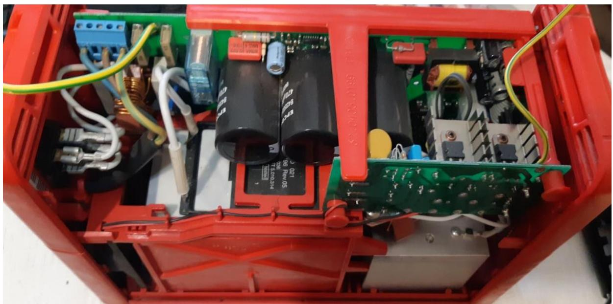
Figure 4. Unutrašnjost izvora za zavarivanje REL postupkom, proizvođača Fronius
