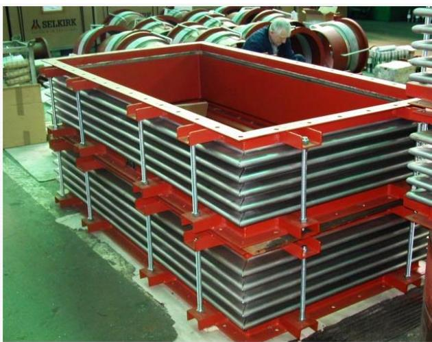
*Figure 6. -a Kompenzatori izrađeni u kombinaciji Ni legura (harmonika MONEL 400) i ugljičnog čelika (cjevni nastavci, prirubnice, uške...)*
