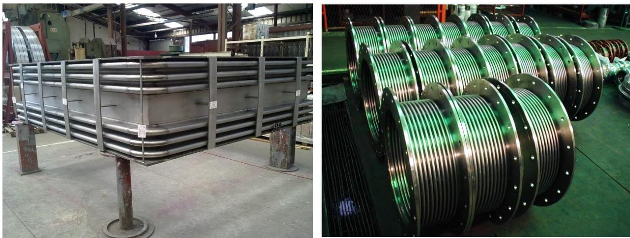
Figure 3. Kompenzatori izrađeni iz Cr-Ni čelika
