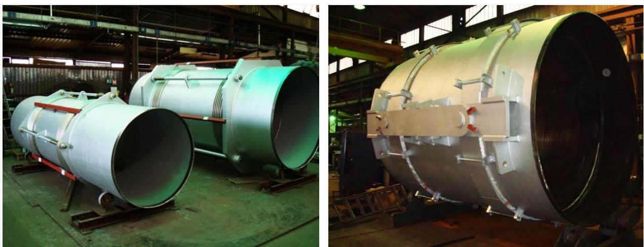
Figure 2. Kompenzatori izrađeni u kombinaciji - Cr-Ni čelika(harmonika) i ugljičnog čelika (cjevni nastavci, prirubnice, poluge, nosači poluga,uške...)
