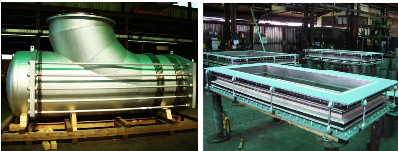
*Figure 4. Kompenzatori izrađeni u kombinaciji- Cr-Ni-Mo čelika(harmonika) i ugljičnog čelika (cjevni nastavci, prirubnice,uške...)*
