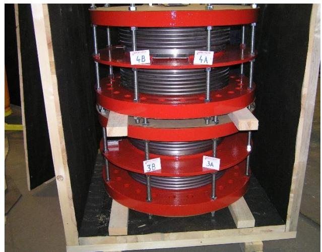
*Figure 6. .-b Kompenzatori izrađeni u kombinaciji Ni legura(harmonika MONEL 400 + 316Ti) i ugljičnog čelika (cjevni nastavci, prirubnice)*
