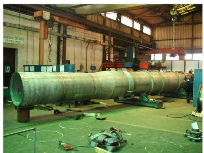
*Figure 5. Kompenzatori izrađeni u kombinaciji vatrootpornog austenitnog čelika(harmonika, cjevni nastavci) i Cr-Ni čelika (poluge, uške)*
