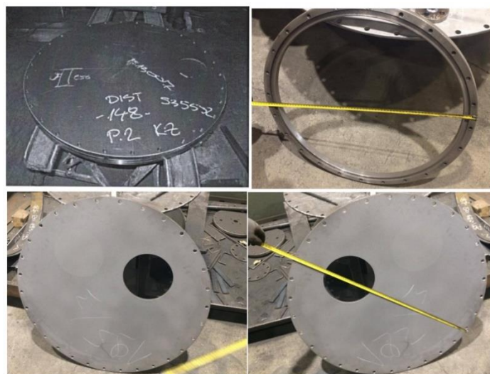
Slika 7 Bušenje prirubnica bočne stijene konzervatora [4]
