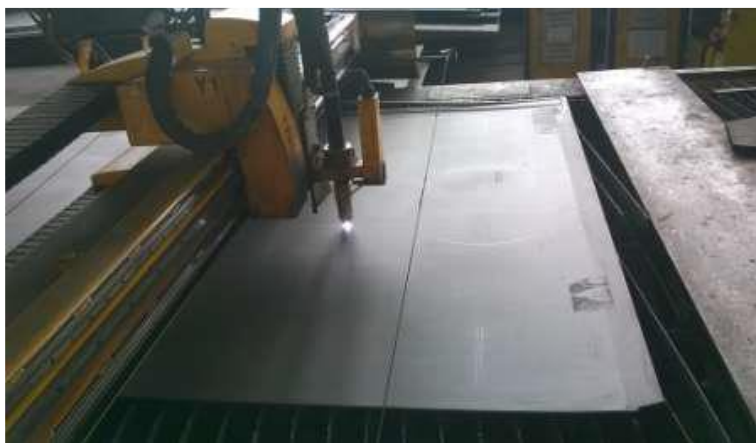
Slika 3 Markiranje ploče konzervatora plazmom [4]
