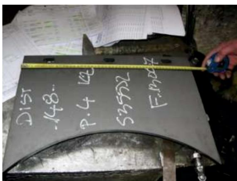
Slika 5 Savijanje nožišta konzervatora [4]
