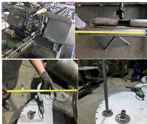
Slika 8 Montiranje prirubnice konzervatora na cijev [4]
