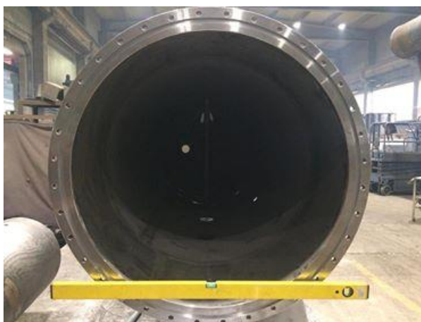
Slika 9 Montiranje prirubnice na plašt konzervatora [4]
