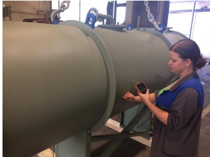
Slika 19 Mjerenje debljine sloja zaštitnog premaza [4]
