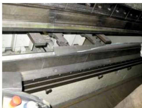
Slika 5 Savijanje nožišta konzervatora [4]
