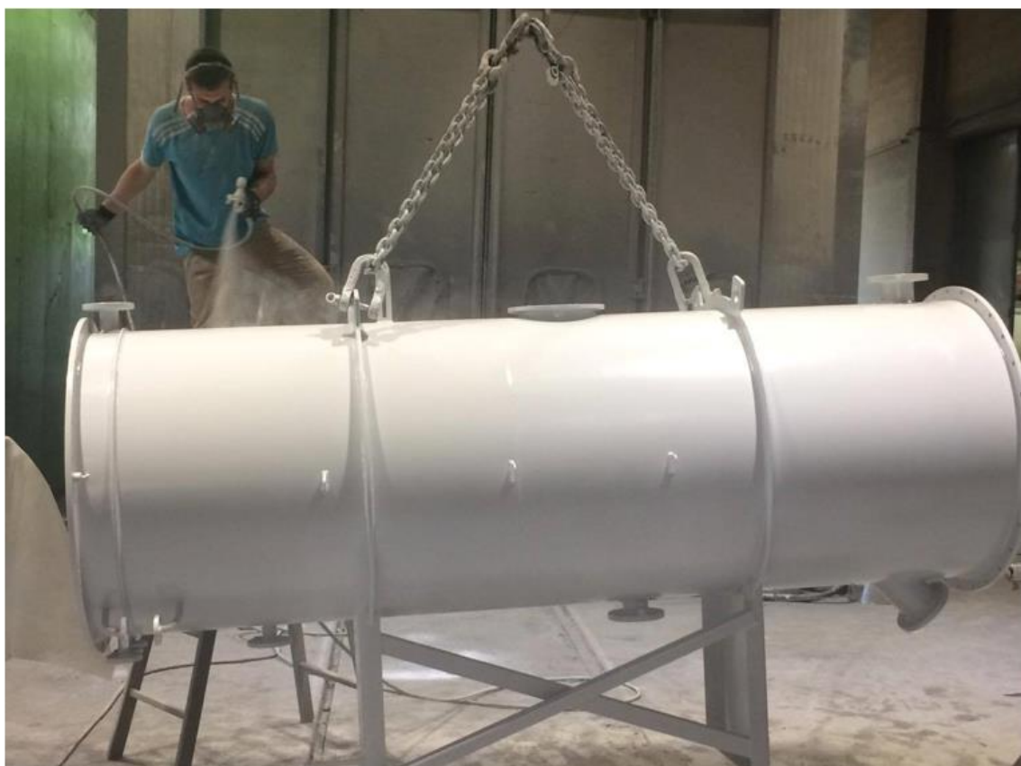
Slika 18 Zaštita vanjskih površina konzervatora premazom [4]
