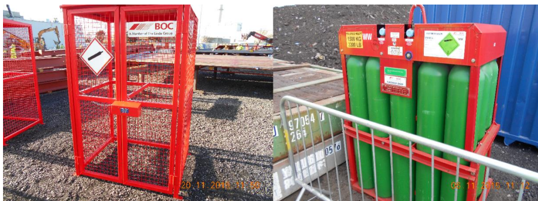
Slika 6 Mobilni kavez za skladištenje plina i paleta sa 15 boca argona [1].
