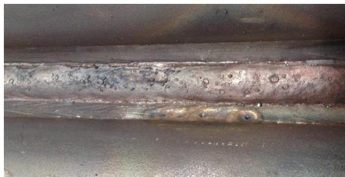
Slika 5 Površinske nepravilnosti otkrivene na zavarenom spoju izvedenom u PA položaju, žicom T MoL P M 2 H5, proizvođača W1
