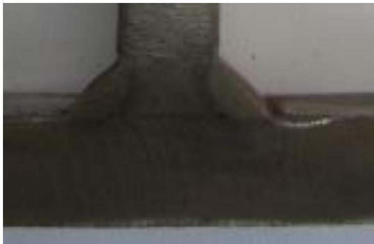
Slika 7 Makro presjek uzorka RP1284/4 pokazuje nepotpunu penetraciju
