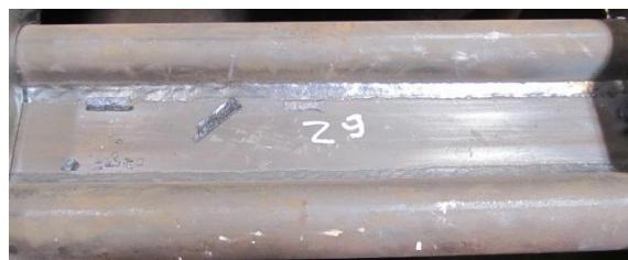
Slika 2. Zavarivanje FCAW brtvenih spojeva traka -cijev membranskih zidova
