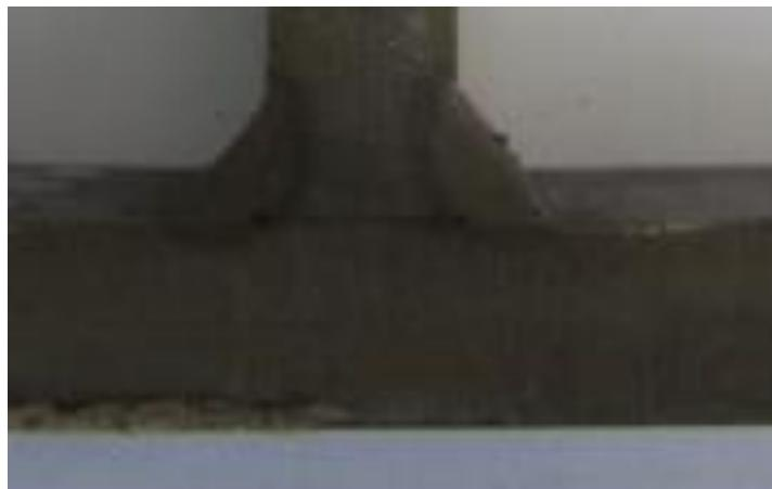
Slika 9 Makro presjek uzorka RP1284/2 pokazuje nepotpunu penetraciju [3]
