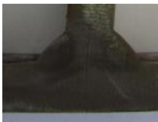
Uzorak RP1284/9 zavaren je u PB položaju uz predgrijavanje na 82°C. Parametri zavarivanja su prikazani u tablici 6.
