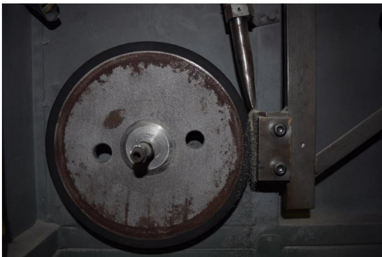
Slika 4 Detalj uređaja za ispitivanje otpornosti na abrazijsko trošenje – gumeni kotač – mlaznica – uzorak
