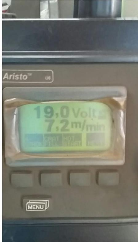
Slika 10 Podešeni parametri zavarivanja
