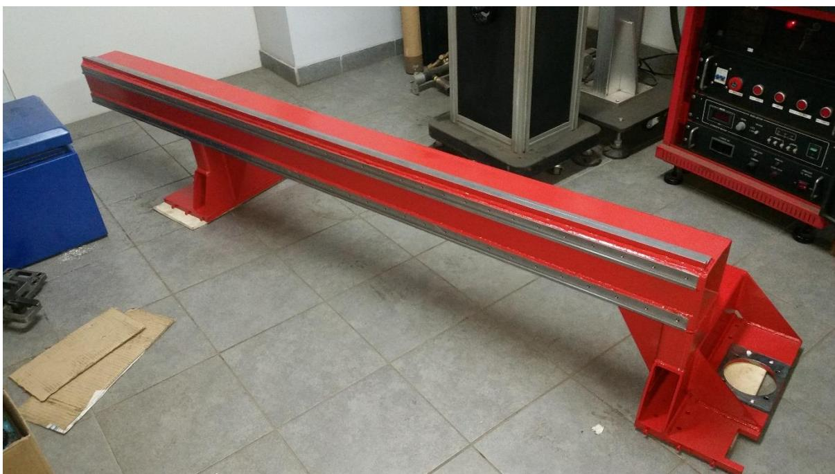
Slika 1 Most CNC laserske rezačice
