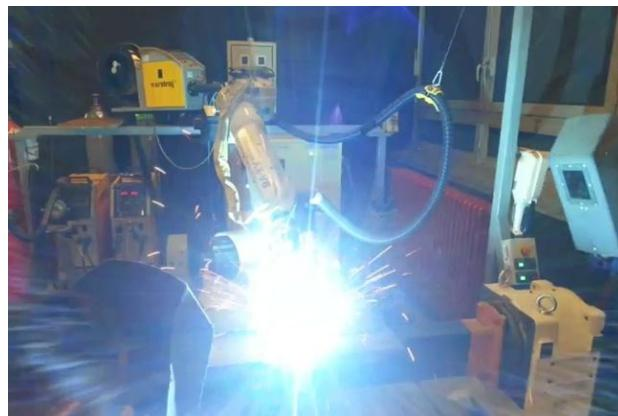
*Slika 1. Zavarivanje pomoći industrijskog robota*
