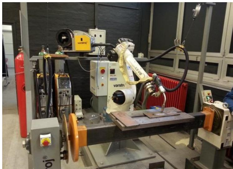
*Slika 2. Robotski sustav u Laboratoriju za zavarivanje, FSB Zagreb*
