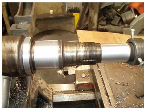
Slika 5. Uklanjanje oštećenja tokarenjem
