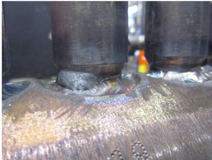
Slika 9. Oksidirana površina lica zavara zbog neispravnog TIG gorionika koji uzrokuje miješanje argona sa zrakom
