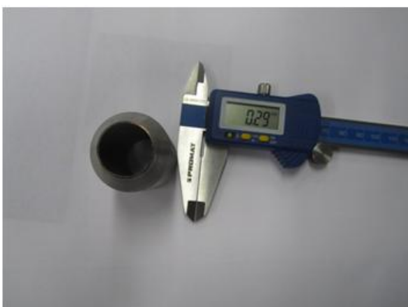
Slika 8. Neodgovarajuća visina nosa na priključku
