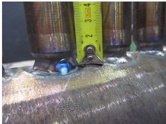
Slika 13. Treći prolaz, geometrija zavara, širina 8 mm
