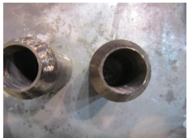
Slika 8. Neodgovarajuća visina nosa na priključku
