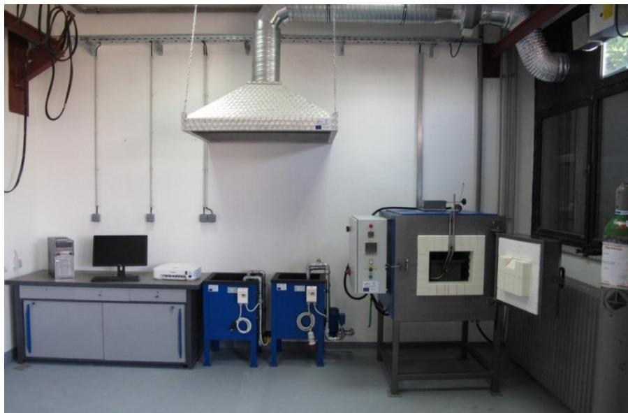
*Slika 1. Peć za toplinsku obradu sa zaštitnom atmosferom i dodatna oprema*
