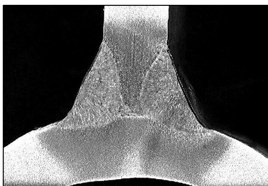
Slika 6. Makro presjek provedene spoja cijev/traka za membranski zid-panel REL postupkom
