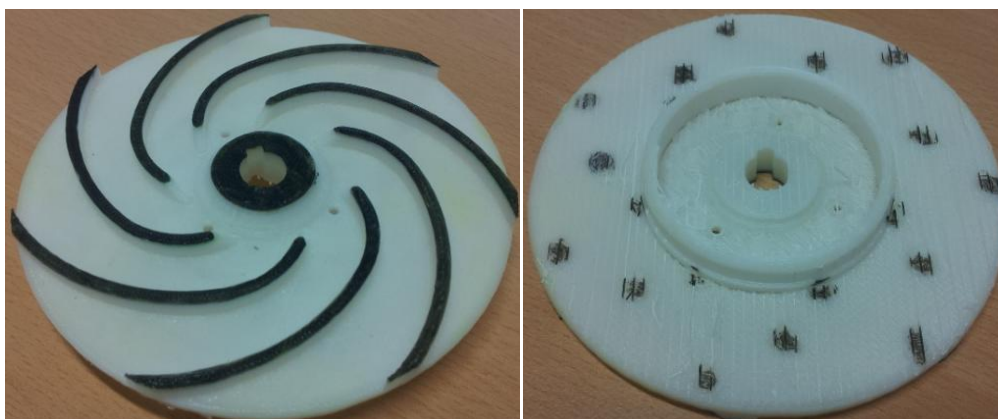
Slika 17. Umanjeni 3D model sklopa glavine i zadnje ploče rotora s lopaticama centrifugalne pumpe u zavarenoj izvedbi ispisan na niskobudžetnom 3D pisaču MakerBot Replicator 2X
