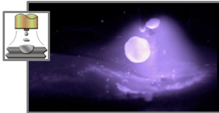
Slika 5. Prikaz prijenosa metala mješovitim lukom [8,9]
