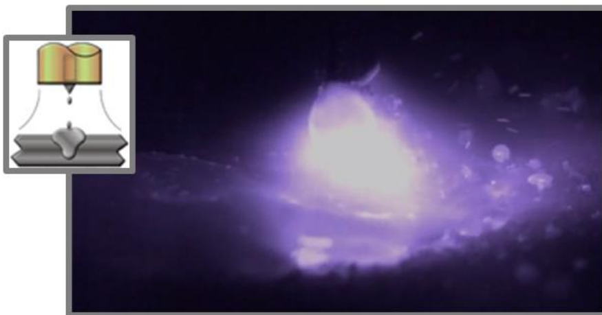
Slika 3. Prikaz prijenosa metala pulsirajućim lukom [8,9]
