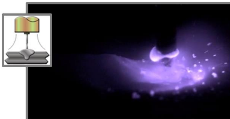
Slika 4. Prikaz prijenosa metala kratkim spojevima [8,9]
