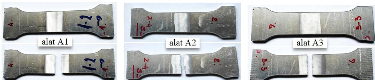
*Slika 18. Izgled epruveta prije i nakon ispitivanja [12]*
