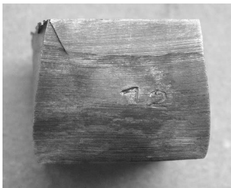
Slika 8. Makro izgled eksperimentalnog uzorka nakon tlačenja i toplinske obrade
