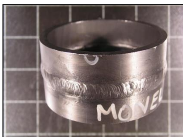
Slika 2. - Zavareni spoj na cijevi Monel 400
