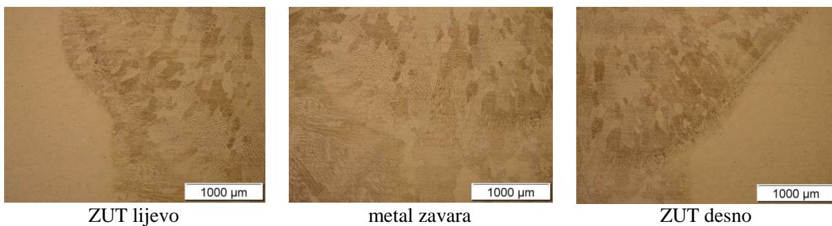
Slika 9. Mikrostruktura zavarenog spoja u sredini zavara
