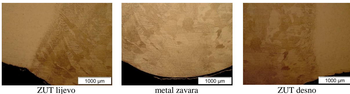
Slika 10. Mikrostruktura zavarenog spoja u korijenu zavara
