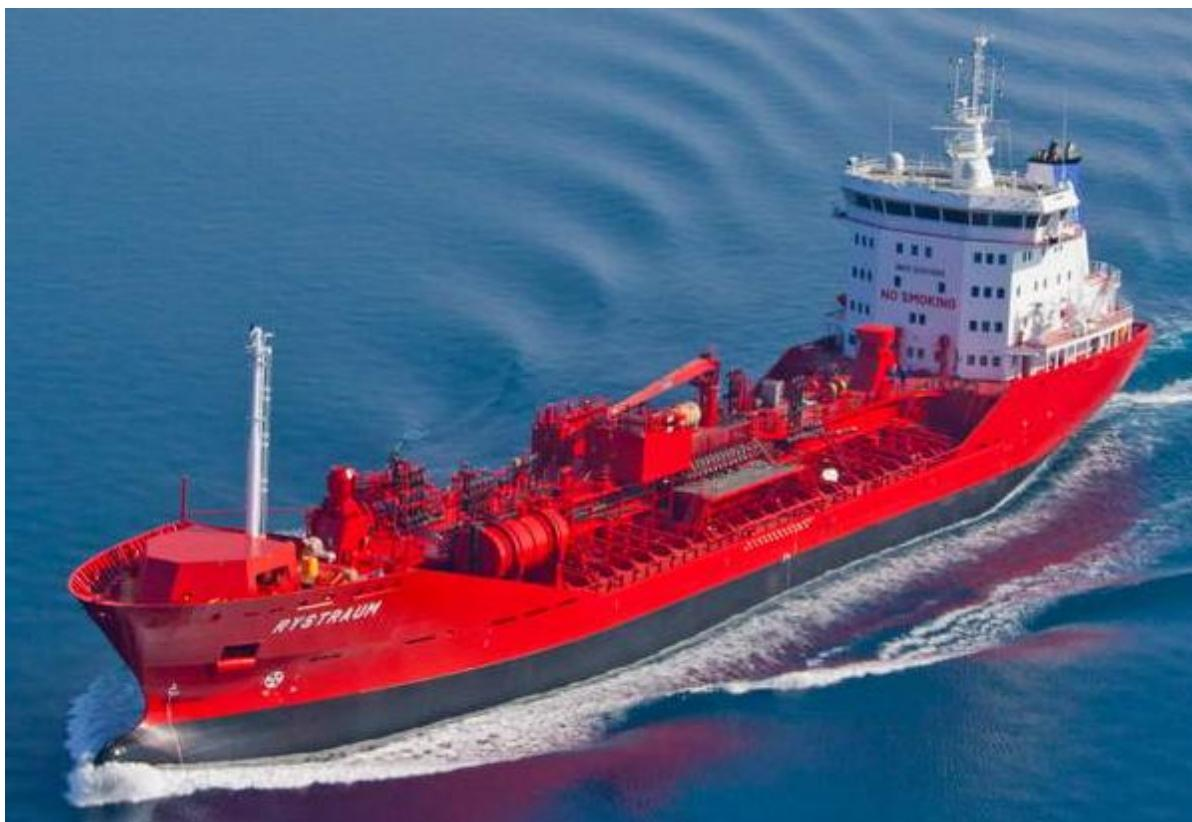
Slika 1. Tanker za prijevoz kemikalija s tankovima izrađenim od duplex čelika
