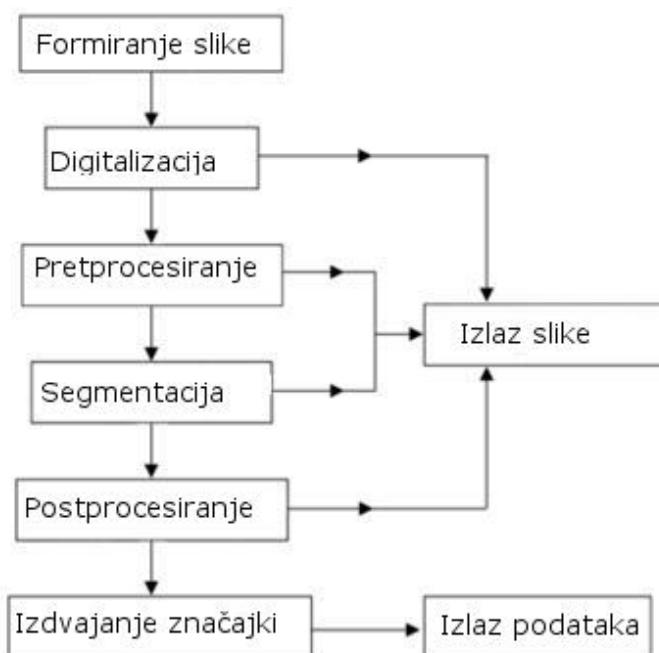
*Slika 1. Proces obrade i analize digitalne slike [1]*
