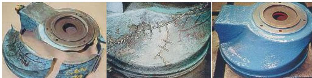
Slika 1. Primjer reparacije lijevanog kućišta Metalock postupkom[7]
