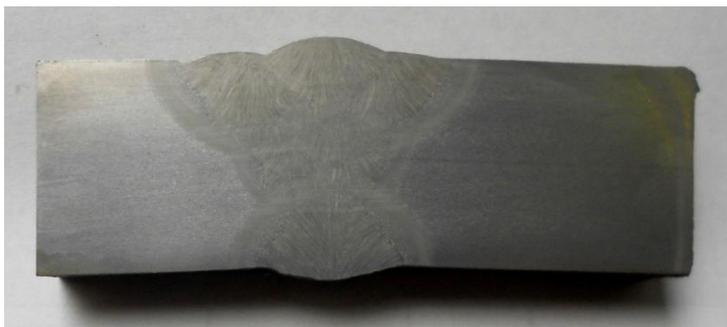
**Slika 6:** Osnovni materijal S690 debljine 20 mm, V spoj obostrano zavarivanje, broj prolaza 11, pozicija PA, praškom punjena žica Filtub 132 promjera 3,2 mm, prašak FBTT, struja DC+.
