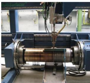
Slika 3: navarivanje valjka po GW postupku sa praškom AB 124
