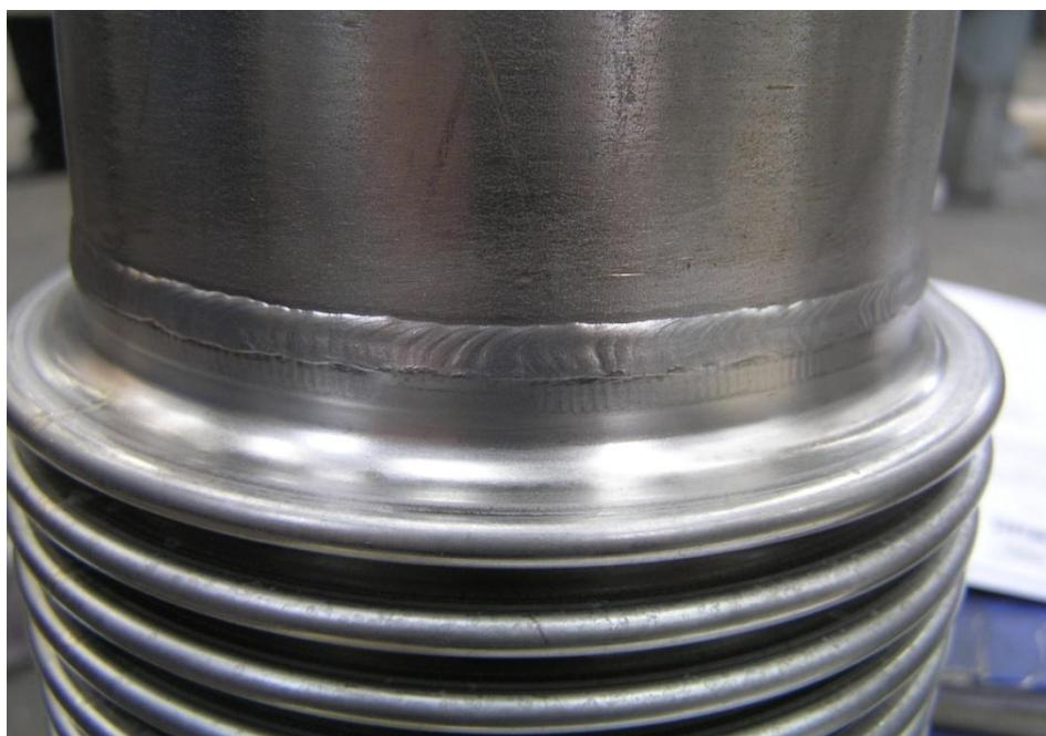
*Slika 3. Zavareni spoj austenitnih čelika uz upotrebu dodatnog materijala*
