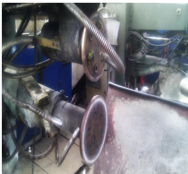
*Slika 3.3 Elektrootporno šavno zavarivanje*
