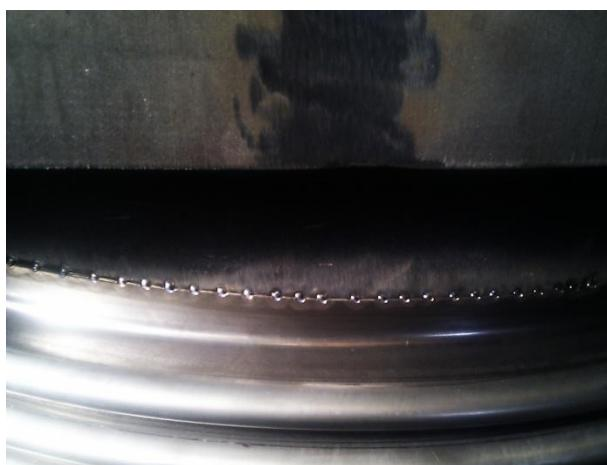
*Slika 3.2 Elektrootporno točkasto zavarivanje*
