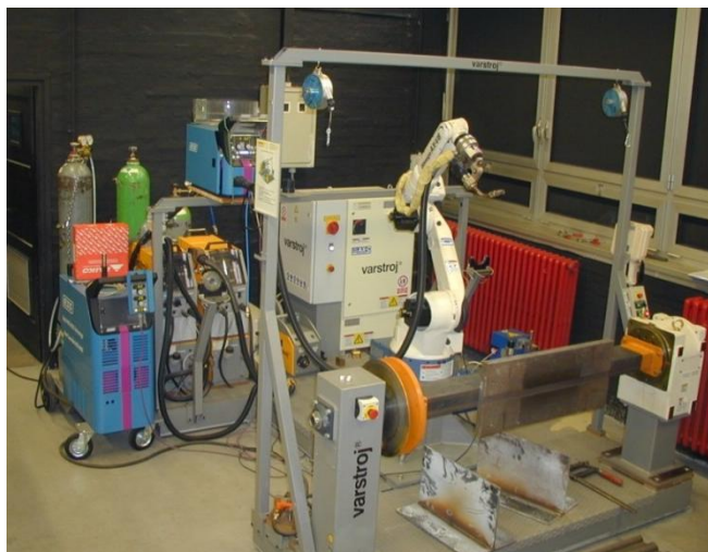
Slika 3. Instalirana oprema za eksperimentalno navarivanje u Laboratoriju za zavarivanje FSB-ZK
