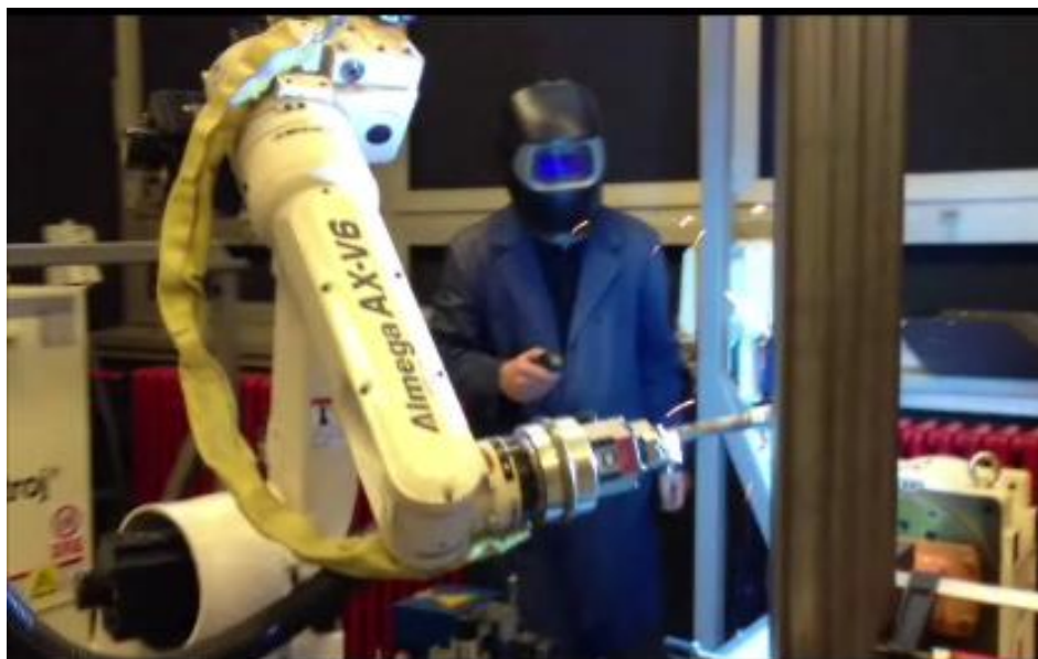
Slika 4. Navarivanje legure Inconel 625 u PG položaju HC MAG postupkom
