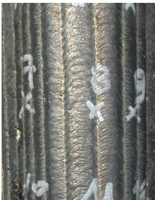
Slika 5. Izgled navarene površine uzorka FSB-03
