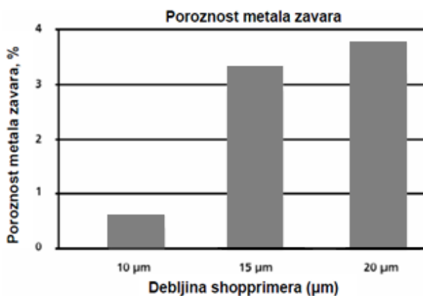
Slika 2. Poroznost metala zavara u ovisnosti o debljini shopprimera [14]
