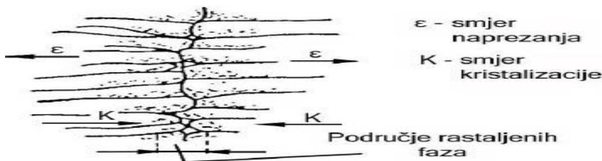
Slika1. Nastanak vrućih pukotina pri skrućivanju metala zavara i utjecajni čimbenici [2]
