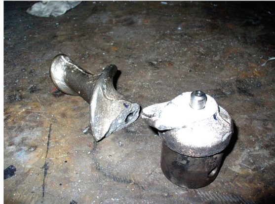
Slika 6. Priprema za sanaciju svrdla
