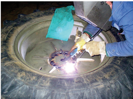
Slika 9. Sanacija naplatka kotača TIG postupkom
