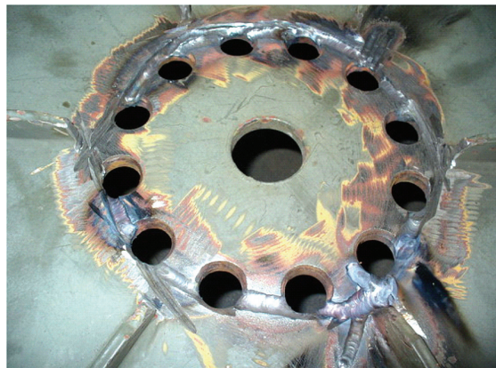
Slika 10. Sanirani naplatak TIG postupkom
