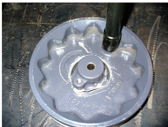
Slika 1. Dio od SL tanke stjenke – prije sanacije
