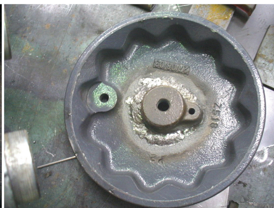
Slika 2. Isti dio saniran TIG/REL postupcima zavarivanja
