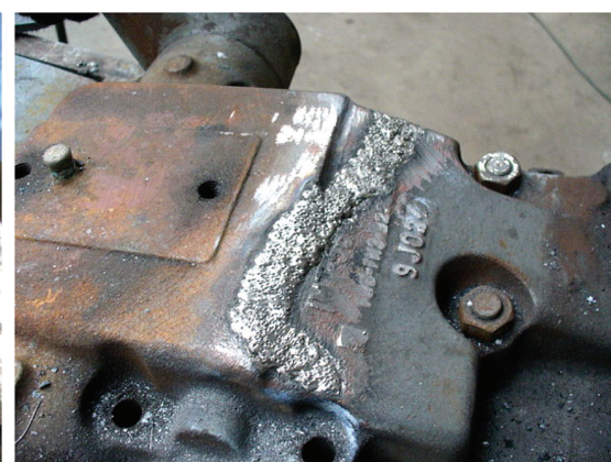
Slika 4. Poklopac mjenjača od SL nakon sanacije
