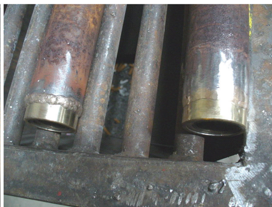
Slika 13. Spoj čelika i bronce
