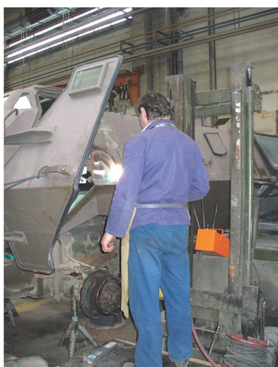
Slika 29. Dogrijavanje nakon zavarivanja
