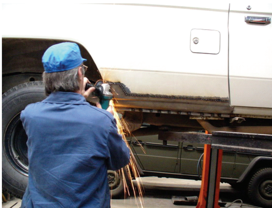
Slika 24. Brušenje točkasto zavarenog spoja
