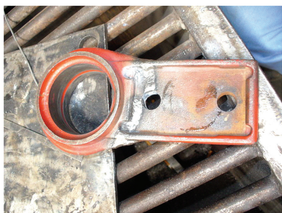
Slika 3. Nosač traktorske kosilice nakon sanacije
