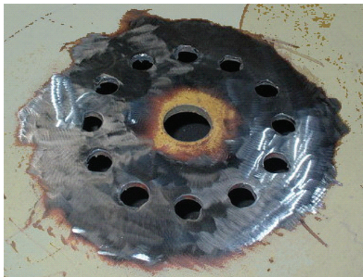
Slika 11. Naplatak nakon poliranja
