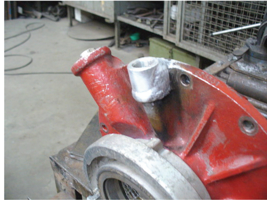
Slika 17. Zavarena čahura od legure Al
