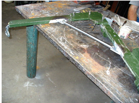
Slika 18. Dizalica ojačana čeličnom šipkom
