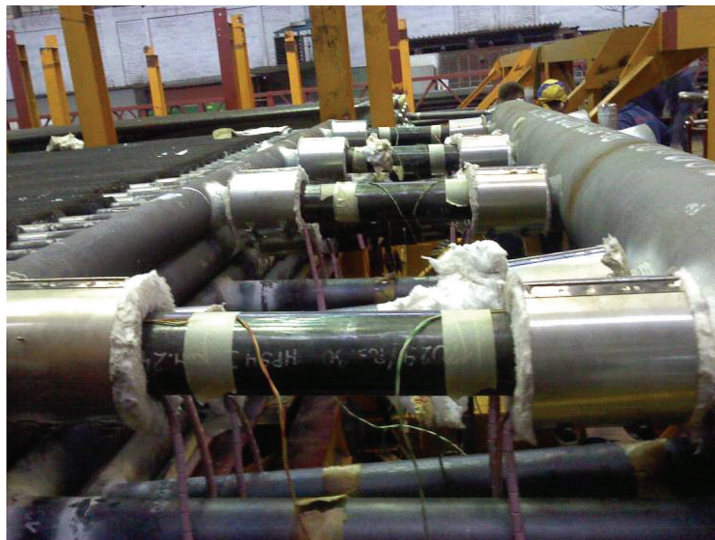
Slika 6.2: Odžarivanje elektrotopnom metodom sučeljenih spojeva spojnih cijevi
