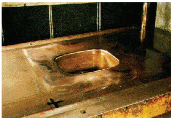
Slika 1: Prikaz alata za duboko vučenje proizvoda od nehrđajućeg CrNi čelika
