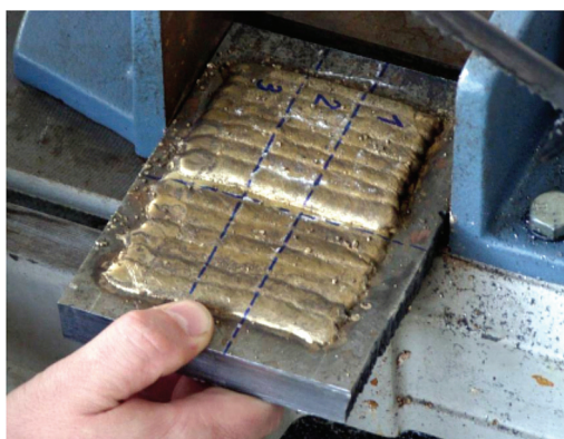
Slika 4: Prikaz aluminijske bronce CuAl-A3 navarene na podlogu od St 52-3 N
