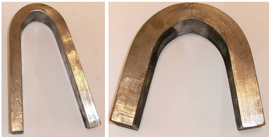
Slika 10. Sučeljeni spoj savijen na lice zavara (3J2 debljine OM 12 mm i 3J1 debljine OM 25 mm)
