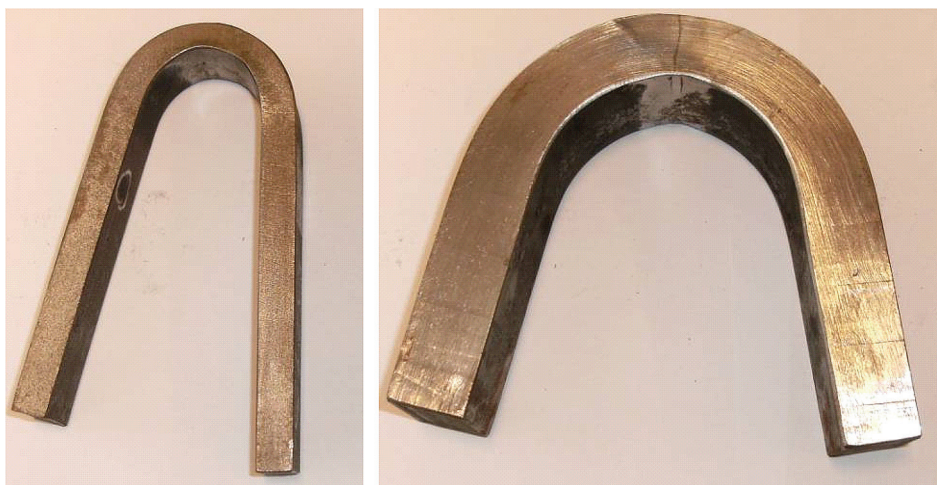
Slika 11. Sučeljeni spoj savijen na korijen zavara (3J2 debljine OM 12 mm i 3J1 debljine OM 25 mm)
