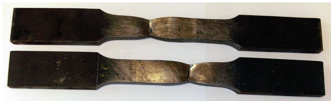
Slika 9. Ispitane (pokidane) epruvete za ispitivanje vlačne čvrstoće spoja (3J1 i 3J2)
