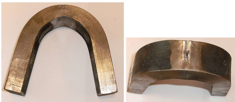
Slika 12. Sučeljeni spoj savijen na lice zavara s pojavom pukotine
