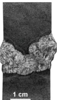
Slika 4: Tipična makrostruktura zavara s MF-33H/US-49 (AWS F8A6-EG-A4)
