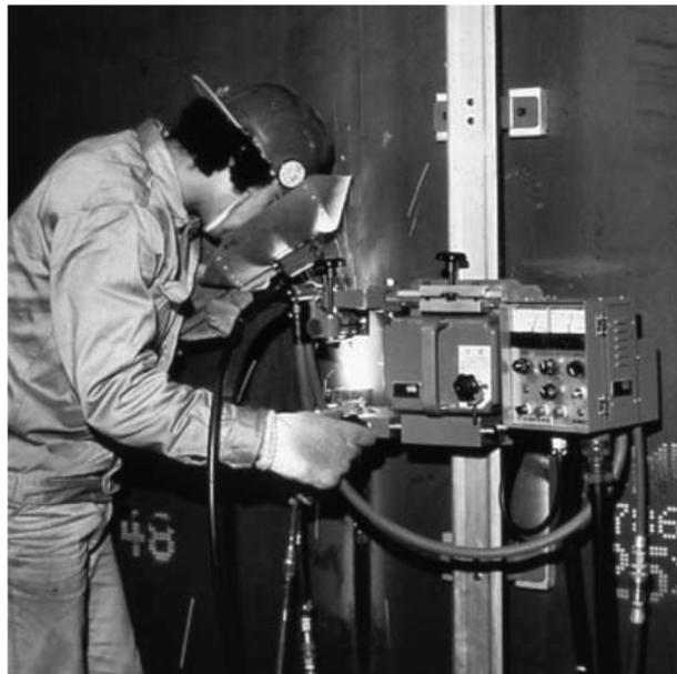
Slika 6: SEGARC postupak – portabilni elektroplinski postupak za vertikalno zavarivanje
