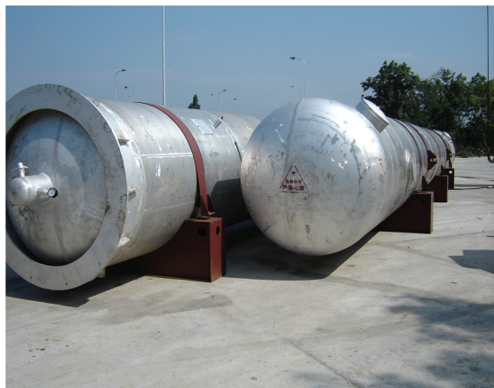
Slika 1. Dijelovi rektifikacijski stupaca prije montaže
