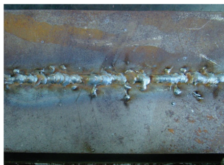
Slika 12. Probni uzorak sučeljenog V spoja – 1 sloj
