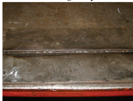
Slika 8. Probni uzorak sučeljenog V spoja – 1 sloj
