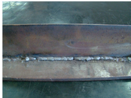
Slika 11. Probni uzorak kutnog spoja
