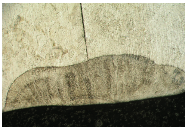
Slika 9. Izgled i makroizbrusak zavarenog spoja načinjenog mikroplazma impulsnim zavarivanjem [6]
