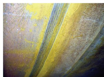
Slika 16. Izgled zavarenog spoja s vanjske strane
