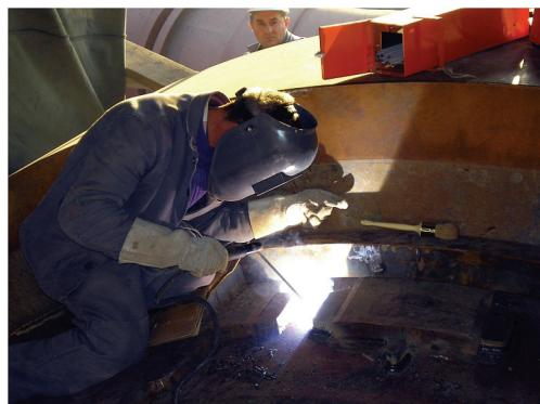
Slika 10. Zavarivanje pozicija na plašt peći
