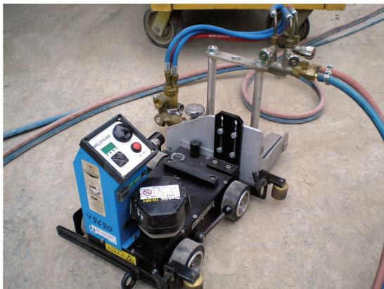
Slika 7. Modificirani uređaj za rezanje WELDY CAR
