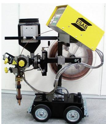
Slika 14. Uređaj za EPP zavarivanje
