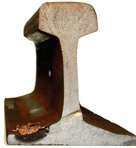
Slika 3. Lomna površina uzorka tračnice
