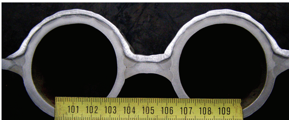
Slika 8. Makro uzorak navarenih slojeva na membranski panel [ 2 ] Figure 8. Macro sample of cladding layers on membrane wall [ 2 ]
