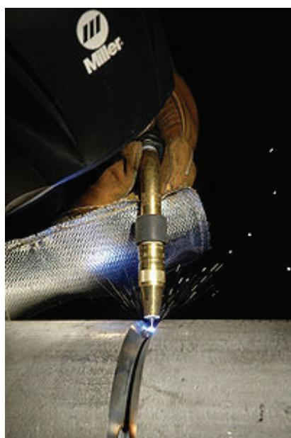
Slika 12. Primjer zavarivanja korijena na cijevi
