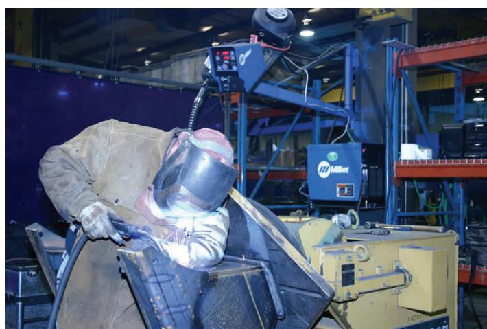
Slika 14. Poluautomatsko zavarivanje dijelova građevinskih strojeva (uočljivo smanjeno prskanje)
