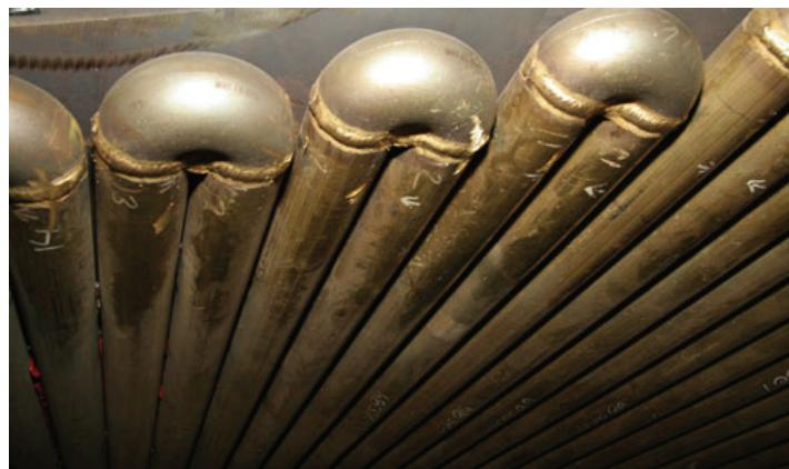
Slika 11. Primjer zavarivanja aluminijске bronce pomoću Axcess uređaja
