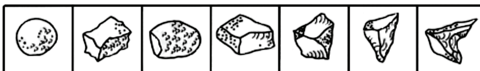
Slika 1. Tipični oblici granatnog abraziva korištenog za AWJM obradu [1]
