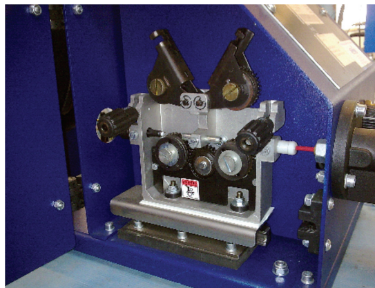
Slika 3. Unutrašnjost dodavača žice, sustav s četiri kotačića
