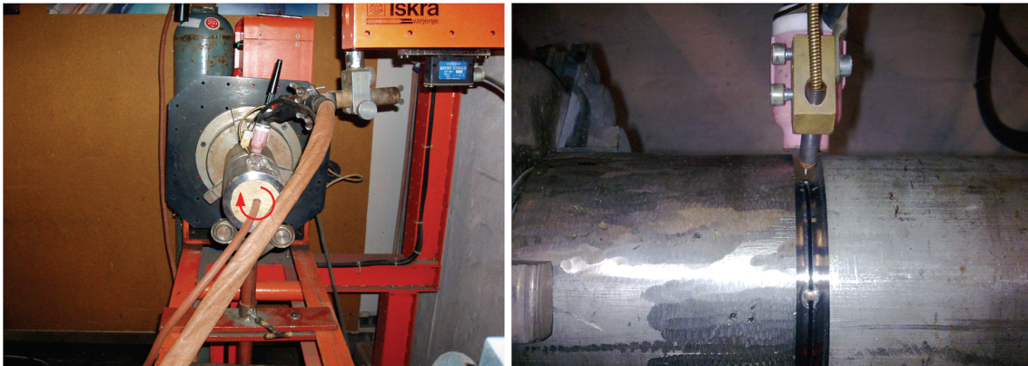
Slika 8. TIP TIG zavarivanje-radno mjesto za zavarivanje cijevi i detalj pripreme žlijeba.
